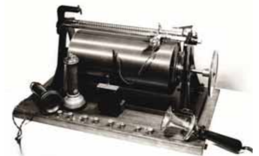
Figura 1. Telegráfono de Poulsen, año 1898. El primer sistema de grabación magnética fue originalmente creado para cumplir las funciones de un contestador telefónico. (Tomado de 'Magnetic recording history pictures', http://history.acusd.edu/gen/recording/tape.html )
