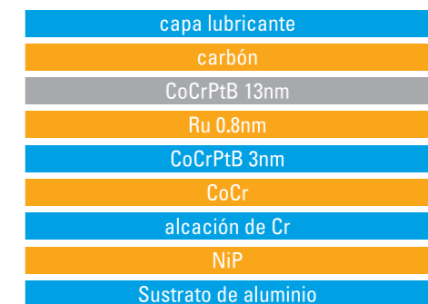
Figura 2. Esquema de una multicapa utilizada como medio en un disco rígido magnético. La estructura de los medios magnéticos se ha vuelto cada vez más compleja debido al incesante aumento en el número de bits por unidad de área. Actualmente son necesarias al menos siete capas (varias con espesores de solo algunas distancias atómicas) para lograr un disco con las características deseadas. De todas ellas la capa gruesa de CoCrPtB (cobalto, cromo, platino y boro; pintada de color gris) es la que guarda la información.
