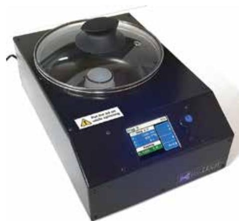
El microcoater de Mutech microsystems es un spin coater de sobremesa muy fácil de usar y lleno de prestaciones, incluye un sistema de vacío integrado con un plato de vacío giratorio y una bomba para sujetar los sustratos a cubrir mientras se gira. No necesita una bomba de vacío externa, está integrada en el interior.
