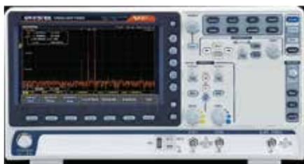
El osciloscopio es un instrumento de visualización que representa gráficamente las señales eléctricas que varían en función del tiempo. Su tarea es presentar los valores en forma de coordenadas en la pantalla, donde normalmente el eje horizontal simboliza el tiempo, y el eje vertical la tensión medida.
