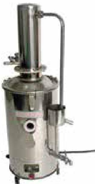
El destilador de agua es un instrumento esencial para la optimización del trabajo en los laboratorios químicos de todo tipo. Debido a la necesidad de agua sin impurezas para los trabajos a desarrollar, este equipo cumple una función principal en cualquier proyecto de la Fundación.
