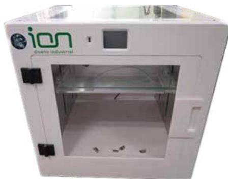
La impresora más grande que cuenta la Fundación tiene la posibilidad de imprimir objetos de hasta 40×40×35 cm (L×An×Al). Diseñado específicamente para el laboratorio de Nanofab, este equipo cuenta con una gran versatilidad que permite proveer soluciones a diferentes problemas del ámbito industrial o de investigación.
