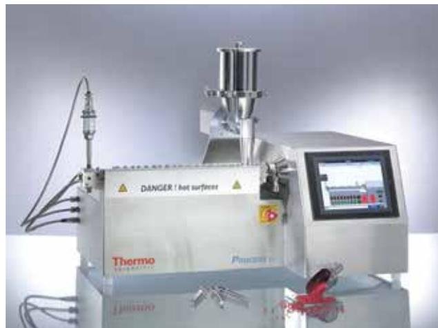
El tamaño reducido disminuye los requisitos de espacio del laboratorio y el menor consumo de ingredientes reduce la exposición del operador y la contaminación medioambiental. Posee un intervalo de rendimiento entre 20 g/h y 2,5 kg/h, con un uso de material de muestra mínimo de 20 g.
