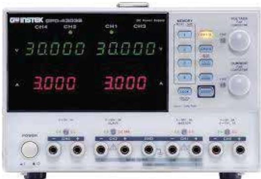
Las tareas relacionadas a componentes electrónicos requieren del equipamiento adecuado. La fuente de corriente es uno de los equipos básicos para estudiar circuitos eléctricos.
