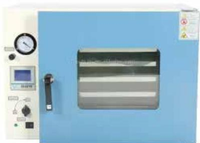
Un método altamente utilizado en los laboratorios es el secado a partir de una estufa de vacío. En el laboratorio NanoFab, se cuenta con el modelo Bluepard DZF-6030A que permite resolver variadas necesidades dentro de los procesos típicos en la producción o uso de nanopartículas.
