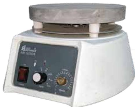
La Fundación Argentina de Nanotecnología cuenta con agitadores magnéticos con capacidad de calefacción. Estos permiten la realización de diferentes soluciones uniformando la mezcla con la posibilidad de utilizar altas temperaturas para mejorar el proceso deseado.
